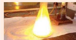
Arderea sodiului în atmosferă de clor 2Na + Cl 2 → 2NaCl
